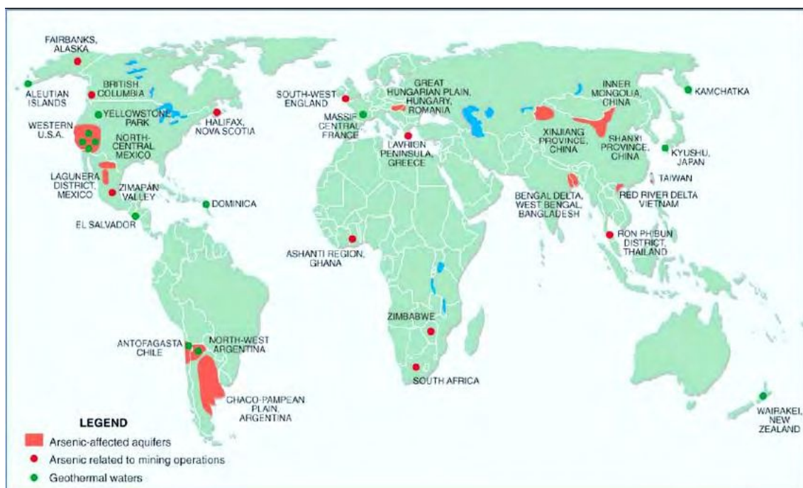
Figura 5. Distribución mundial de áreas con presencia de arsénico en aguas subterráneas. Las áreas en azul son lagos. Extraído de Smedley y Kinniburgh, 2002.
